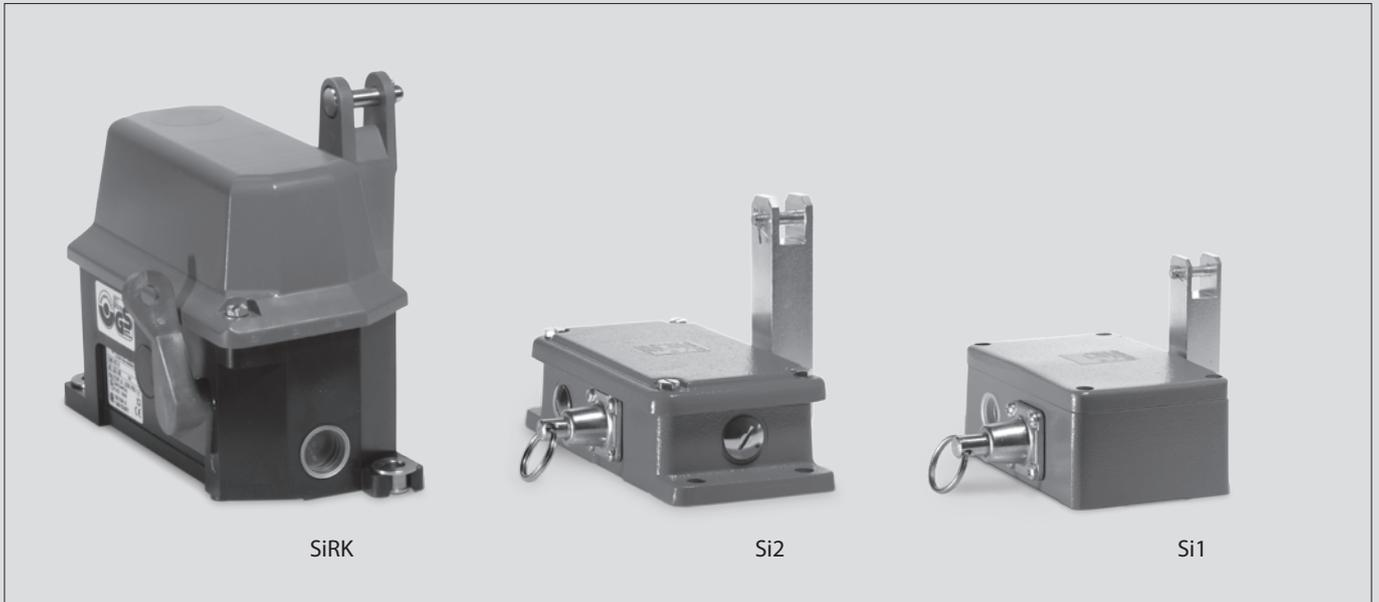
Beidseitig abspannbare BERNSTEIN Sicherheits-Seilzugschalter (der SiRK, Si1 und Si2) sind ebenfalls für Not-Halt Anwendungen einsetzbar. Durch Betätigen des Zugseils wird der Schalthebel in die jeweilige Richtung ausgelenkt und die Anlage abgeschaltet.
